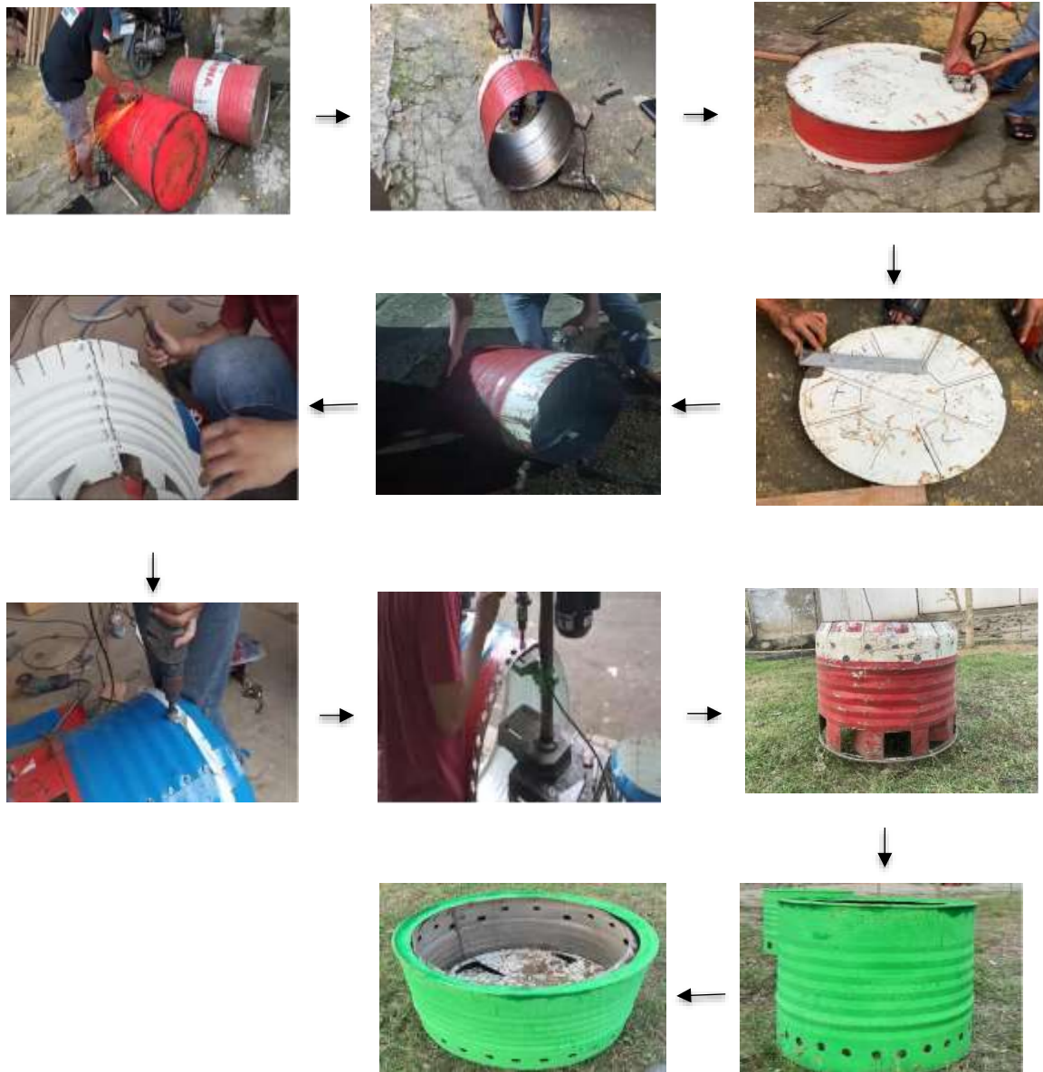
Gambar 1. Tahapan pembuatan pembakaran sampah
