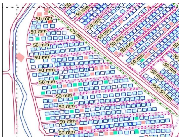
Gambar 1. Peta jaringan pipa Perumda Air Minum Tirta Mayang Kota Jambi di Perumahan Bougenville Sumber: Perumda Air Minum Tirta Mayang Kota Jambi
