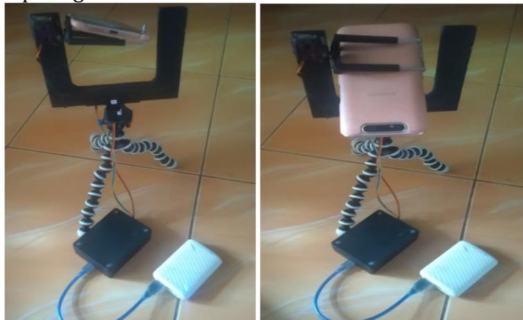
Gambar 8. Motor Servo Dan Holder Tidak Dapat Menahan Beban Saat Motor Bergerak Kebawah
